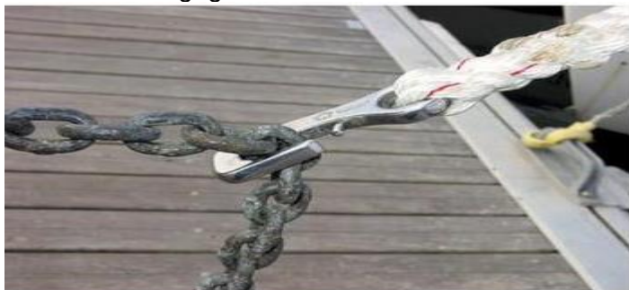
Doigt de la main de fer dans un maillon de la chaîne
